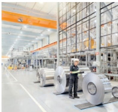
Sandviks produktionsenhet för belagda band, som bland annat används i energi-effektiv bränslecellsteknologi, Sandviken.
