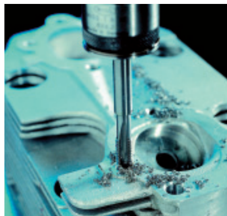
Prototyp inom Sandvik CTT introducerade en ny typ av gängtappar för bearbetning av rostfria och höglegerade stål.
