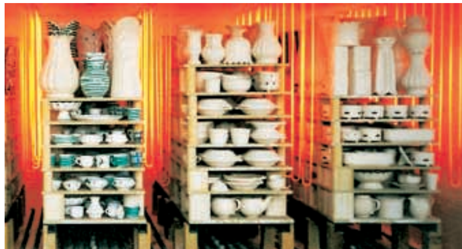
Värmelement från Kanthal används i ugnar vid tillverkning av bl a keramik.
