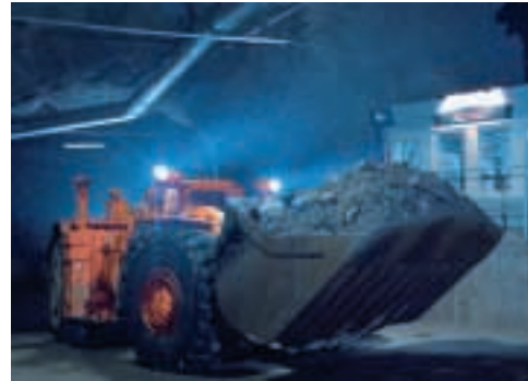
Sandvik Tamrock ligger långt framme inom området automatisering av underjordsgruvor. En operatör som befinner sig ovan jord kan genom ny teknik fjärrkontrollera obemannade lastare.
