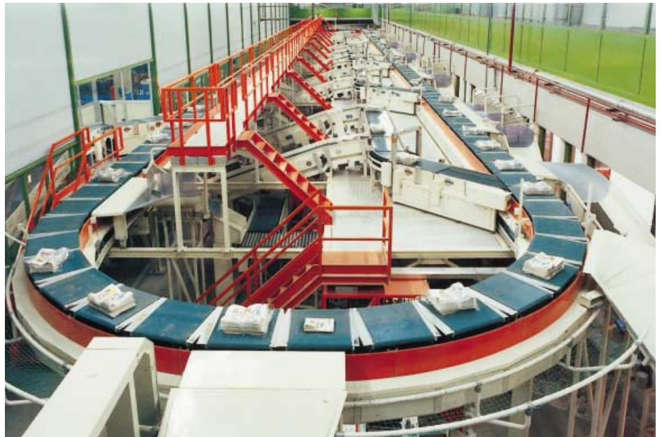
CMLs sorteringssystem SBIR för tidningsdistribution används av bl a La Stampa, en av Italiens största tidningar
