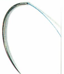
Sandvik Steels Tråddivision har tagit fram en ny stålsort som möjliggör tillverkning av extremt tunna och hållfasta kirurgiska nålar att användas för ögonoperationer.
