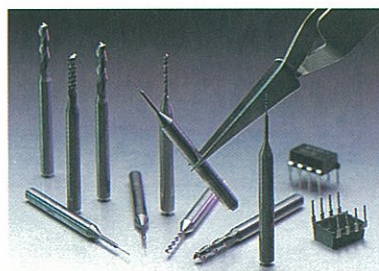
Ultrafinkornig hårdmetall utgör basen i ett snabbt växande produktprogram för ämnen till mikroverktyg för elektronikindustrins allt mindre kretskort.
