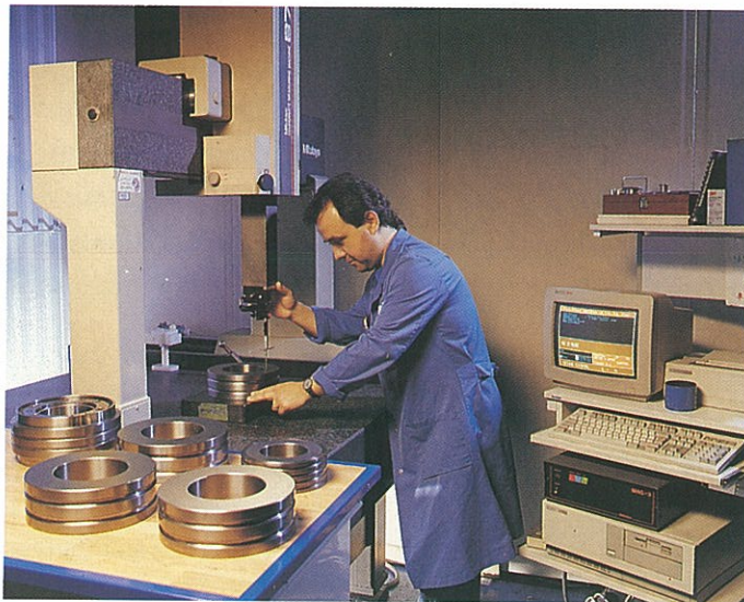
Vid slutkontrollen av Sandviks hårdmetallvalsar upprättas protokoll med mätdata för varje enskild vals.
