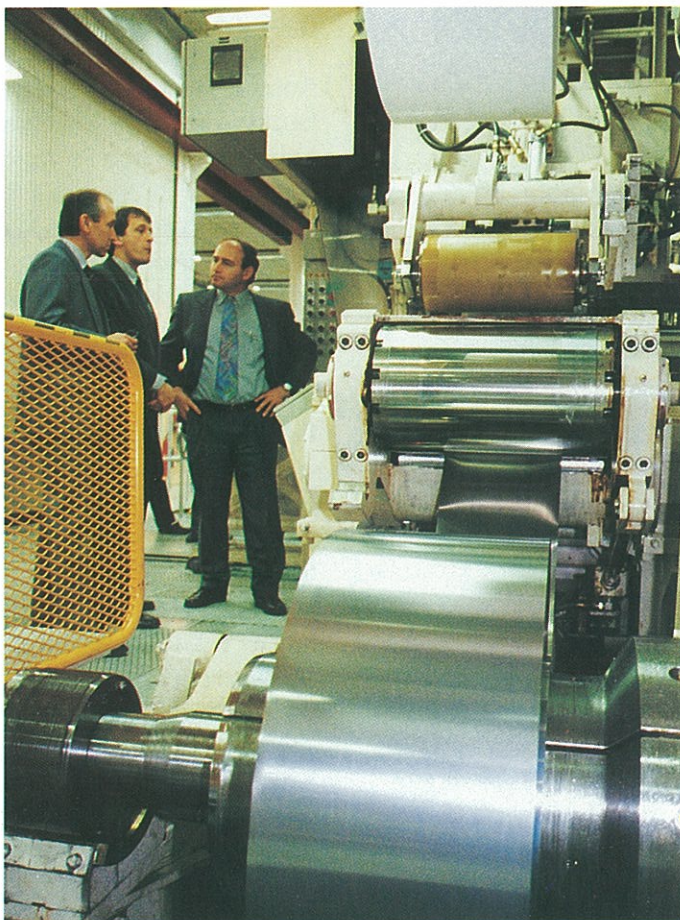
Under 1994 togs ett nytt kallvalsverk i bruk för ökad produktion av tunna band, som används främst för rakblad och i katalytiska avgasrenare. Vid invigningen i Sandviken deltog representanter från betydelsefulla kunder.
