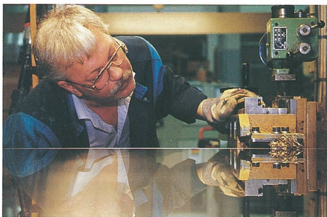
Kantbearbetning är ett viktigt moment i tillverkningen av breda stålband i Sandviken. På bilden kontrollerar Bengt Forsberg att resultatet blir bra.
