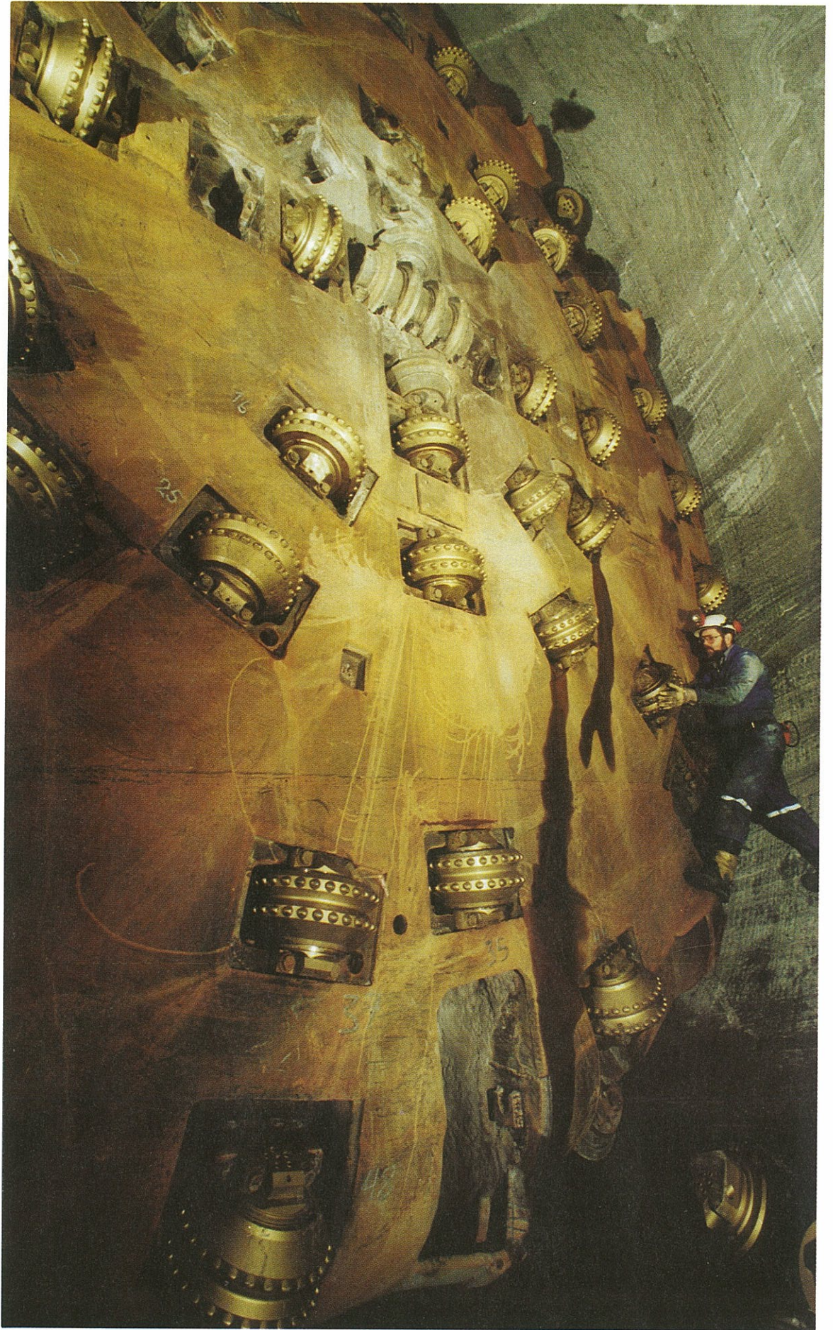
Sandviks nya hårdmetallrullar på en 8,5 m tunnelborrningsmaskin i ett kraftverksprojekt under Svartisen i Norge.
