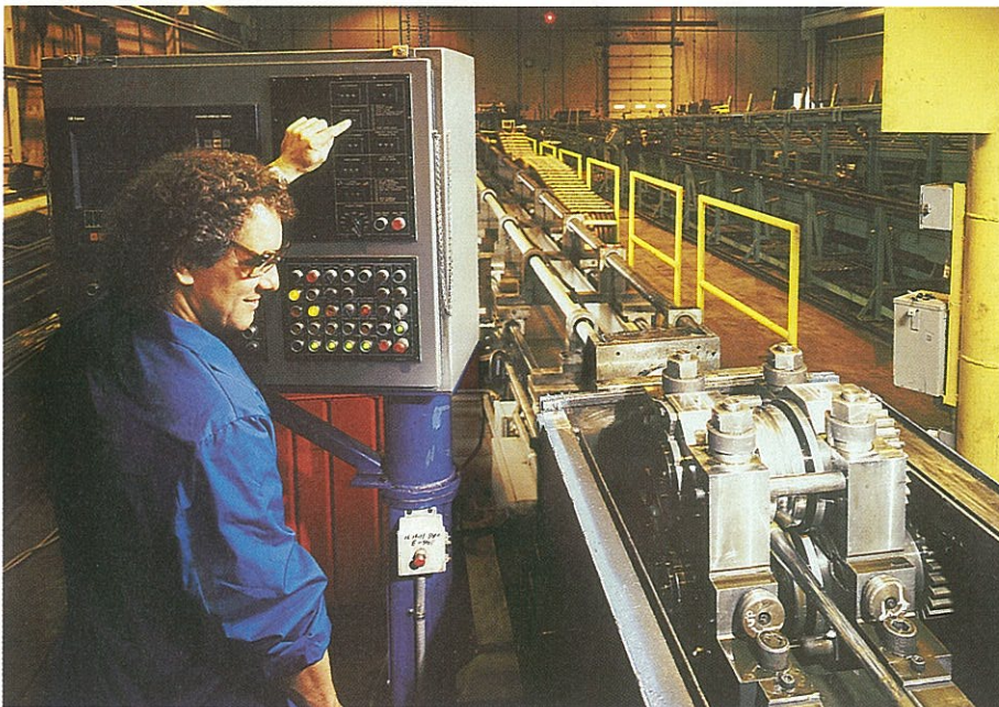
Specialkonstruerade stegvalsverk för rationell tillverkning av precisionsrör i kläna dimensioner har installerats vid våra anläggningar i Sverige och USA.
