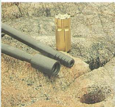
NY TYP AV SKARVSTÅNG MED FAST HYLSA OCH BORRKRONA FÖR BORRNING AV RAKA HÅL.
