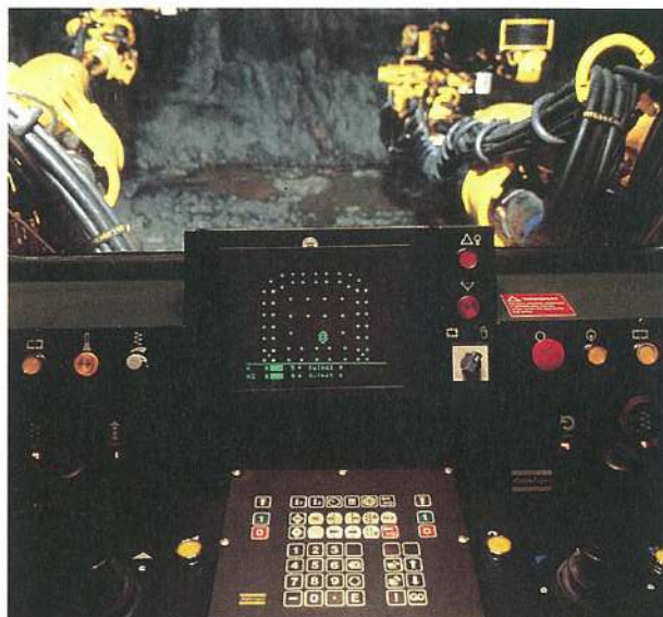
DATORISERAD BORRIGG, ATLAS COPCO ROBOT BOOMER, FÖR OBEMANNAD BORRNING AV SPRANGHÅL VID TUNNELDRIVNING.
