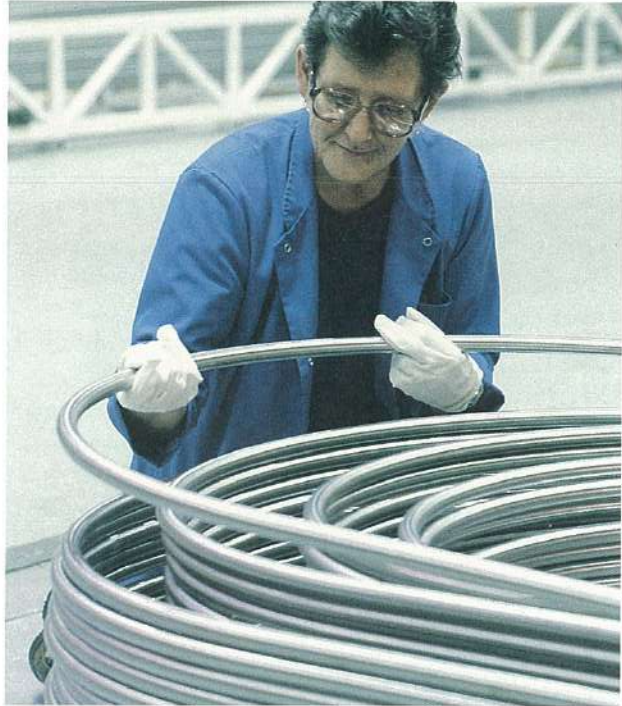
ÅNGGENERATORRÖR TILL KÄRNKRAFTVERK STÄLLER STORA KRAV PÅ LEGERINGENS EGENSKAPER.
