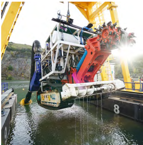
Sandvik bidrog till undervattensprojektet med ett hydrauldrivet fräshuvud på 150 kilowatt, idealiskt för bearbetning av solitt berg.
